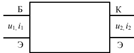
Рис. 3.28: Представление биполярного транзистора как линейного четырехполюсника.
