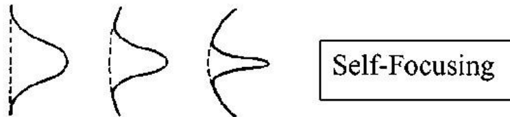
Рисунок 8. Схема искажения волнового фронта светового пучка в процессе самофокусировки в кубично-нелинейной среде. Иллюстрация взята из работы [16].
