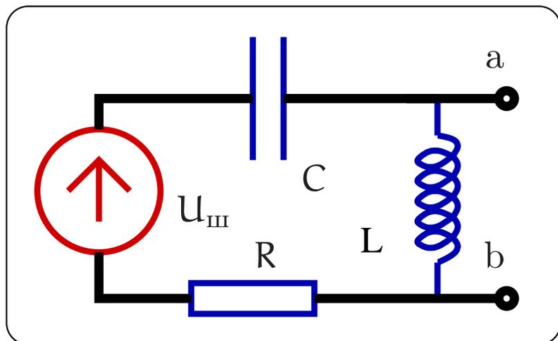
Пусть  $S(\omega)$  — спектральная мощность шумового напряжения  $U_{ш}$ . Какова спектральная мощность  $S_{ab}(\omega)$  напряжения  $U_{ab}$ ?
