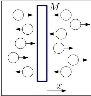
Рис. 1.6: Одномерная модель броуновской частицы массы  $M$  и поперечного сечения  $S$ , которая может двигаться только по оси  $x$ . Случайно ударяющиеся с обеих сторон молекулы создают случайную тепловую силу  $F_{\text{fl}}$ . Они же создают и вязкость.
