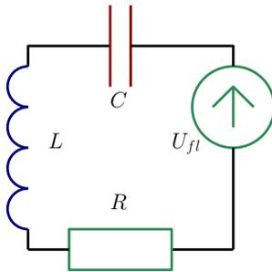
Рис. А.1: Параллельный колебательный контур. Наличие сопротивления  $R$  является причиной тепловых шумов в контуре (генератор  $U_{fl}$ ).
