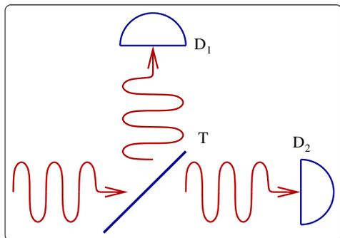
Рис. 3.1: При достаточно слабом потоке фотонов (строго говоря, когда на вход падает однофотонное состояние) на полупропускающее зеркало всегда щелкает только один детектор: или  $D_1$ , или  $D_2$ .
