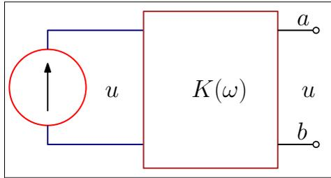
Рис. 1.4: Схема преобразования шума, проходящего через линейное устройство.
