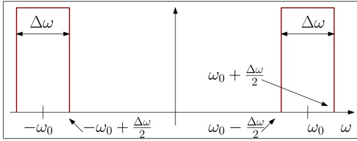
Рис. 1.2: Полосовой фильтр пропускает только частоты  $\omega_0 - \frac{\Delta\omega}{2} < \omega < \omega_0 + \frac{\Delta\omega}{2}$  и  $-\omega_0 - \frac{\Delta\omega}{2} < \omega < -\omega_0 + \frac{\Delta\omega}{2}$ .
