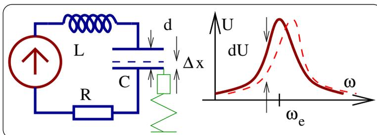
Рис. 2.1: Схема емкостного датчика. Смещение  $\Delta x$  механического осциллятора, прикрепленного к пластине конденсатора, вызывает изменение напряжения  $dU$  на конденсаторе.
