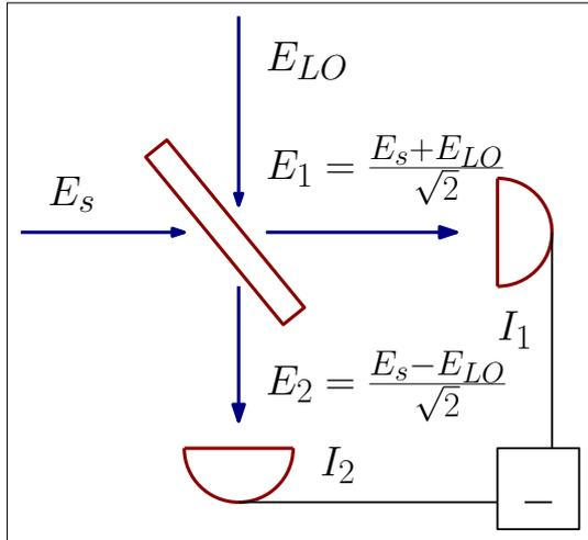
Рис. 3.13: Балансная гомодинная схема разрушающего измерения квадратурной компоненты сигнальной волны  $E_s$ . Амплитуда  $E_{LO}$  опорного генератора велика:  $E_{LO} \gg E_s$ .
