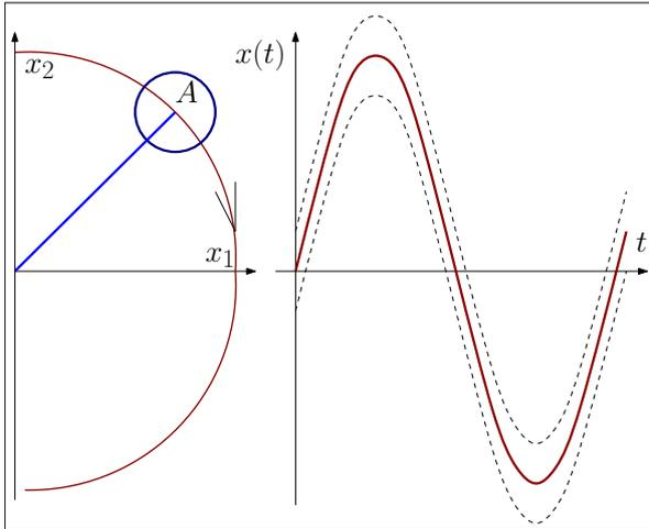
Рис. 3.9: Фазовый портрет и временная эволюция когерентного состояния: средняя величина (точка **A**) эволюционирует по классическим законам, а флуктуации квадратурных компонент постоянны и не коррелированы (круг на фазовом портрете)
