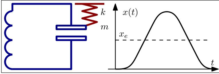
Рис. 3.6: Схема пондеромоторного измерителя энергии. Энергию в LC-контуре измеряют по воздействию на механический осциллятор, координату которого регистрируют с точностью СКП (измеритель координаты не показан).
