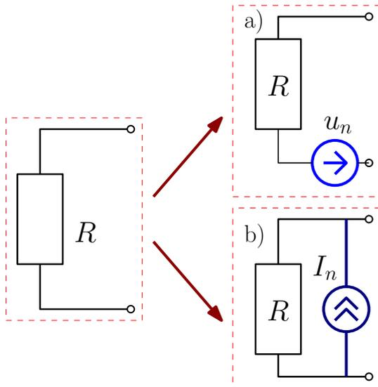
Рис. 1.5: Представление реального сопротивления  $R$ , как нешумящего сопротивления с шумовым генератором напряжения  $u_n$  (a) или тока  $I_n$  (b).
