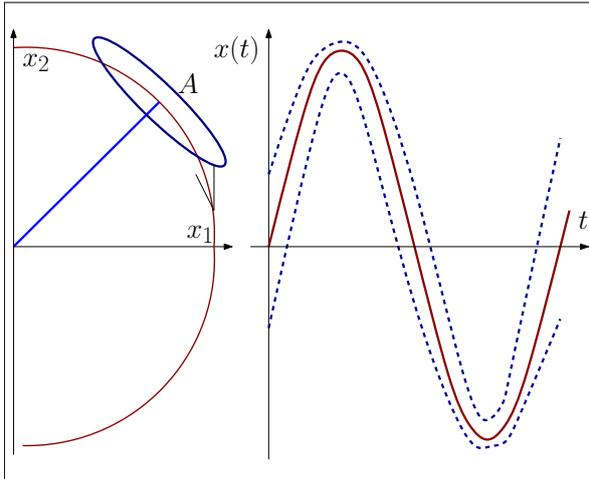
Рис. 3.11: Фазовый портрет (слева) и временная эволюция (справа) сжатого по *амплитуде* состояния: средняя величина эволюционирует по классическим законам, а флуктуации квадратурных компонент НЕ постоянны (эллипс на фазовом портрете)
