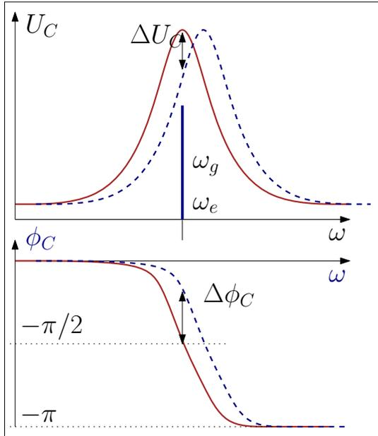
Рис. 2.2: При смещении  $\Delta x$  пластин емкостного датчика амплитудно-частотная (вверху) и фазово-частотная (внизу) характеристики смещаются. При резонансной настройке ( $\omega_g = \omega_e$ ) амплитуда напряжения на емкости изменяется слабо ( $\Delta U_C \sim (\Delta x)^2$ ), но значительно изменяется фаза ( $\Delta \phi_C \sim \Delta x$ ).
