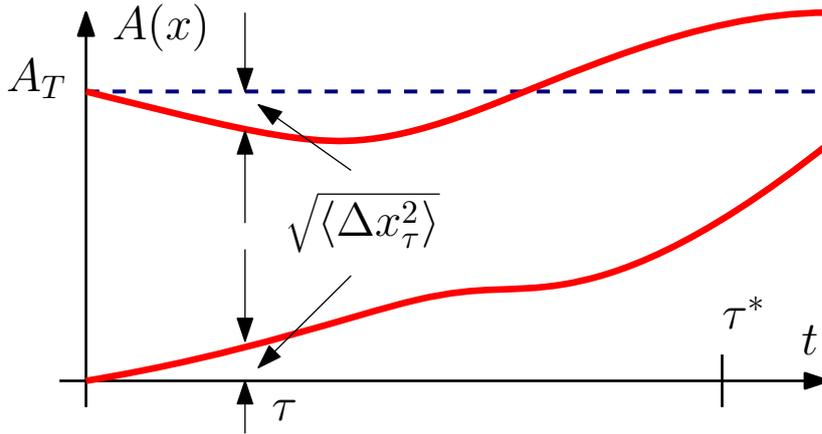
Рис. 1.8: Изменение амплитуды высокодобротного резонатора  $A$  под действием тепловых флуктуаций. Средняя тепловая амплитуда равна  $A_T = \sqrt{\frac{k_B T}{m\omega_m^2}}$ .
