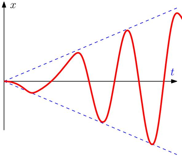
Рис. 1.7: График зависимости координаты осциллятора  $x(t)$  под действием резонансной силы (1.59).
