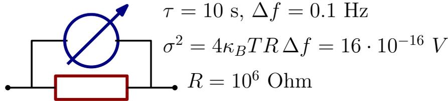
Рис. 4.1: Схема измерения тока.
