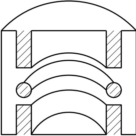
Рис. 3.8: Схема пондеромоторного измерителя световой энергии в кольцевом диэлектрическом резонаторе с использованием нелинейности диэлектрической проницаемости.
