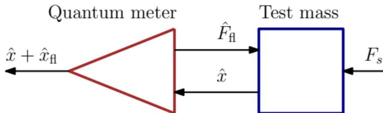
Рис. 5: Экв. схема линейного измерителя квантовой пробной массы
