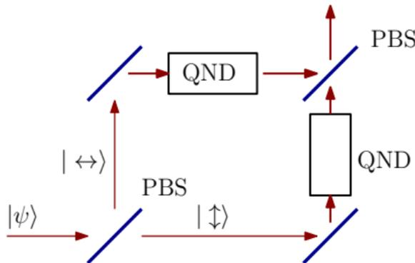
Пусть нач. состояние  $|\leftrightarrow\rangle$  или  $|\downarrow\rangle$ . После измерения оба возможных пути фотона объединяются вторым PBS.
