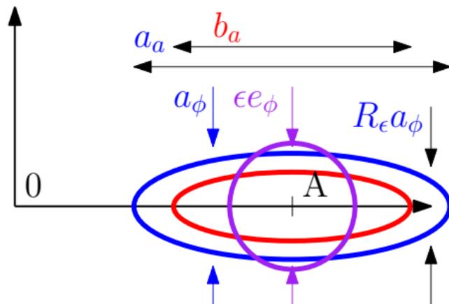
Рис. 7: При отражении от зеркала с оптическими потерями сжатие падающего света (синий эллипс) деградирует (сумма красного эллипса и фиолетовой сферы).
