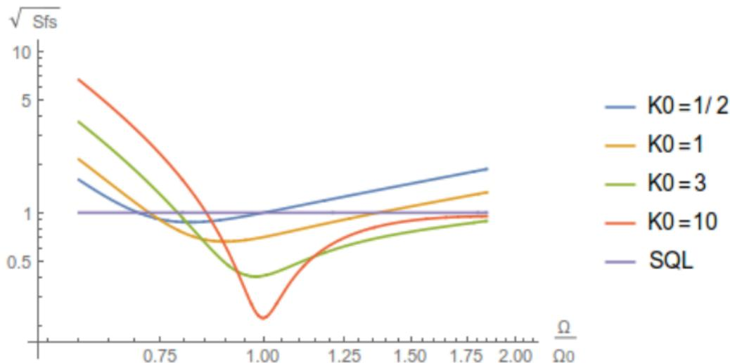
Рис. 6: Графики чувствительности  $\sqrt{S_{fs}(\Omega)}$  для вариационного измерения
