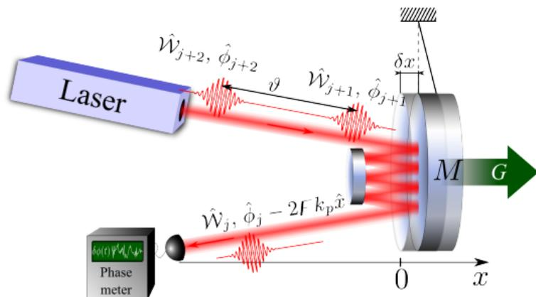
Рис. 4: Упрощенный пример оптического измерения координаты массы.
