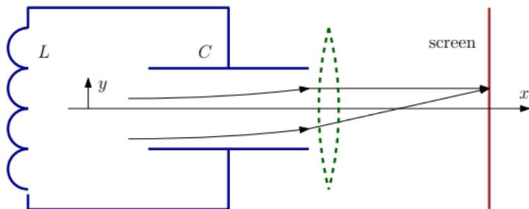
Рис. 3: Схема косвенного измерения с помощью электронного зонда
