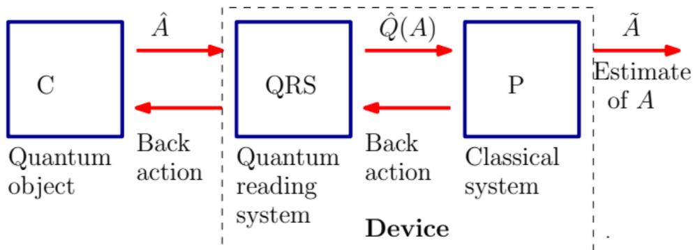
Рис. 2: Схема косвенного измерения. С – квантовый объект, QRS (ККС) – квантовая считывающая система, P – классический наблюдатель, осуществляющий редукцию.
