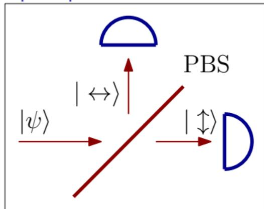
Измерение поляризации фотона.
