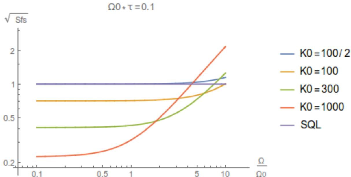
Рис. 8: Графики чувствительности  $\sqrt{S_{fs}(\Omega)}$  для координатного измерителя скорости, параметр  $\Omega_0 \tau = 0.1$ . Ср. с графиками на Рис. 6.
