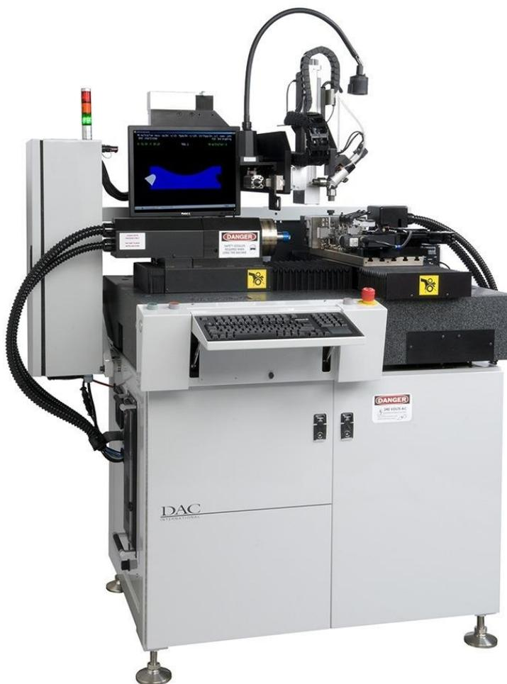
Рисунок 13. Прецизионный станок алмазного точения DAC ALM Lathe. Иллюстрация взята из работы [14]. Более детальное описание станка и изображения его рабочей области можно найти в работе [4].
