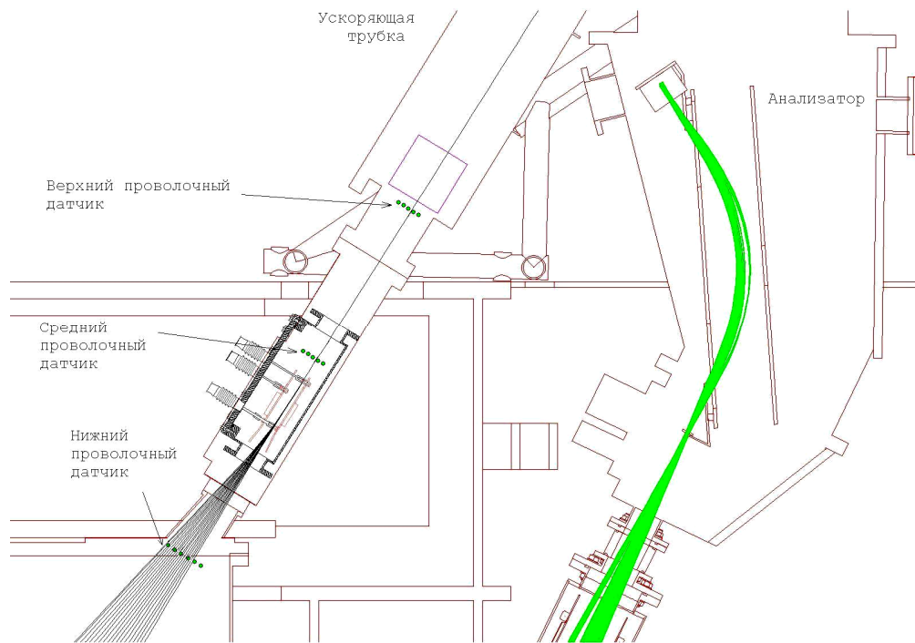
Рис. 4. Расположение проволочных датчиков в первичном ионопроводе Т-10.
