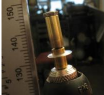
Рис. 15: Снимок отполированного и сформованного резонатора
